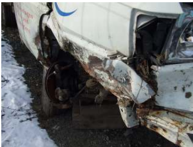
Altfahrzeug mit gebrochener Achse - gefährlicher Abfall End-of-life vehicle with broken axle - hazardous waste (Photo: BMLFUW)
