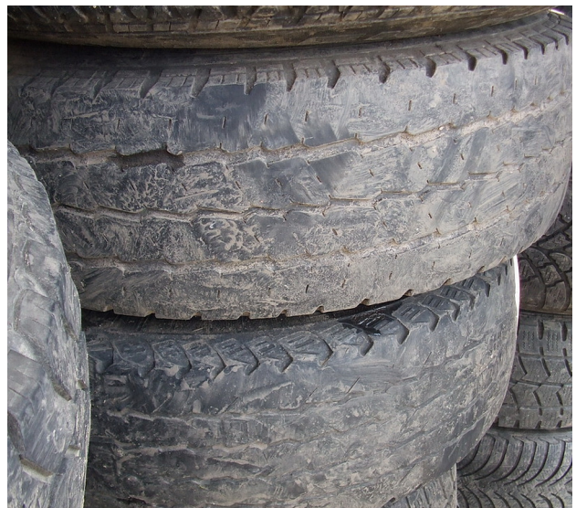
Altreifen ohne die erforderliche Profiltiefe für die Wiederverwendung - Abfall Waste tires with insufficient tread depth for reuse - waste (Photo: BMLFUW)
