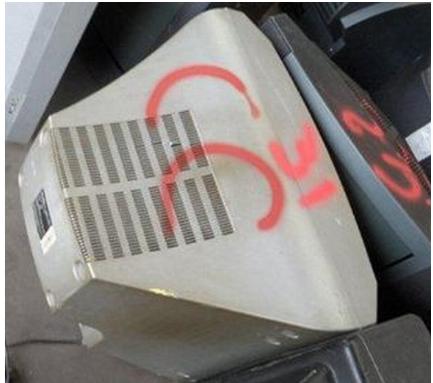
Gebrauchte Monitore mit abgeschnittenen Netzkabeln, kein Prüfzertifikat der Testung - gefährlicher Abfall Used monitors, power cables cut-off, no certificate of testing - hazardous waste (Photo: BMLFUW)
