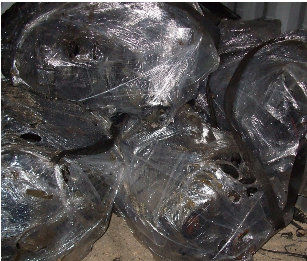
Folierte Altmotoren, kein Prüfzertifikat der Funktionsfähigkeit - Abfall / gefährlicher Abfall Foiled waste engines without certificate of testing - waste / hazardous waste (Photo: BMLFUW)
