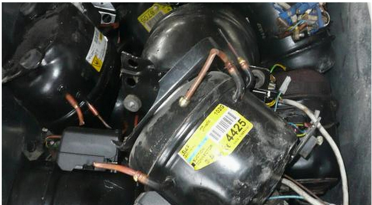
Alte Kompressoren mit unterschiedlichen Kältemitteln, kein Prüfzertifikat, keine Verpackung – gefährlicher Abfall
